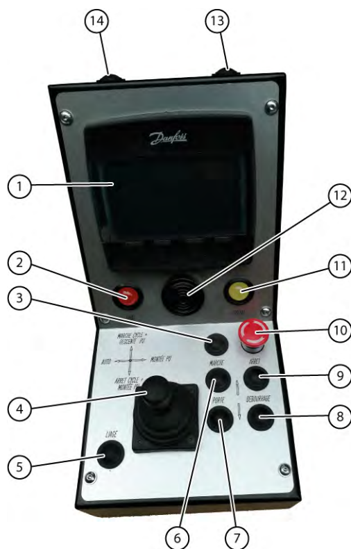
Fig. 46 Console de commande
