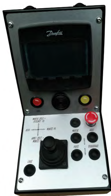
Fig. 12 Console de commande
